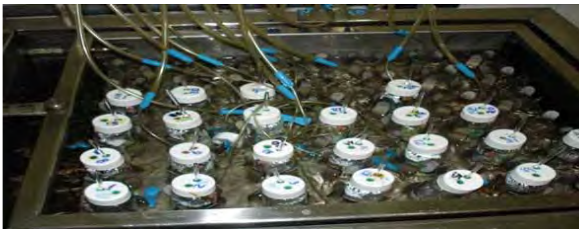
Figura 1. Sistema de incubação para medida do metabolismo de glicose no músculo sóleo. A) Frasco de incubação e aparato para a colocação de líquido de absorção de CO 2 ; B) Frasco de incubação montado e C) Banho.
